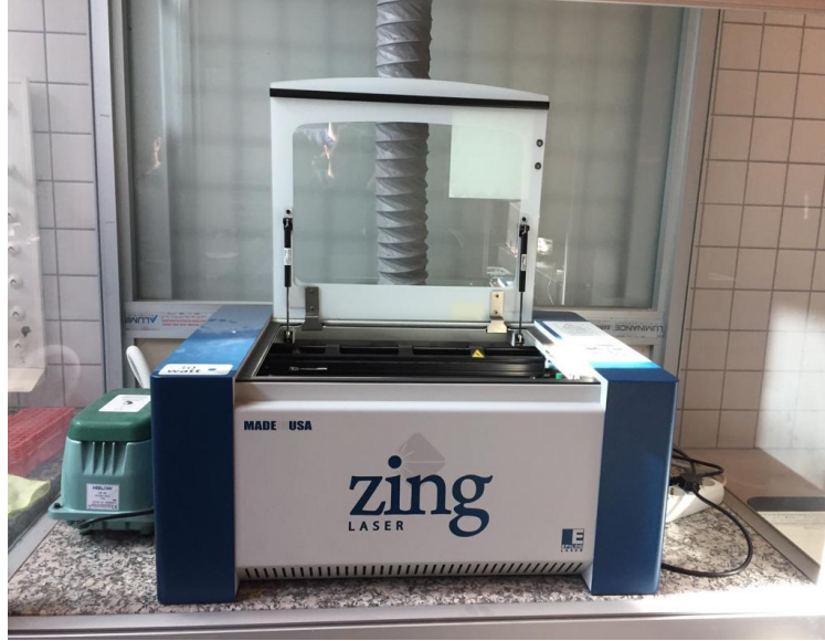
Şekil 21. Lazer kesici ve havalandırma sistemi.
