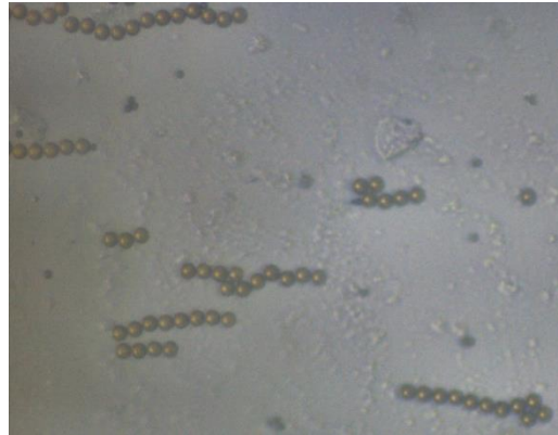
Şekil 28. Dış manyetik alan altında mikro-parçacıkların topaklanması.
