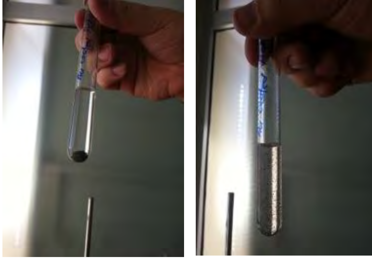
Şekil 5. AgNW'ların altın kaplandıktan sonra agregasyona uğraması
