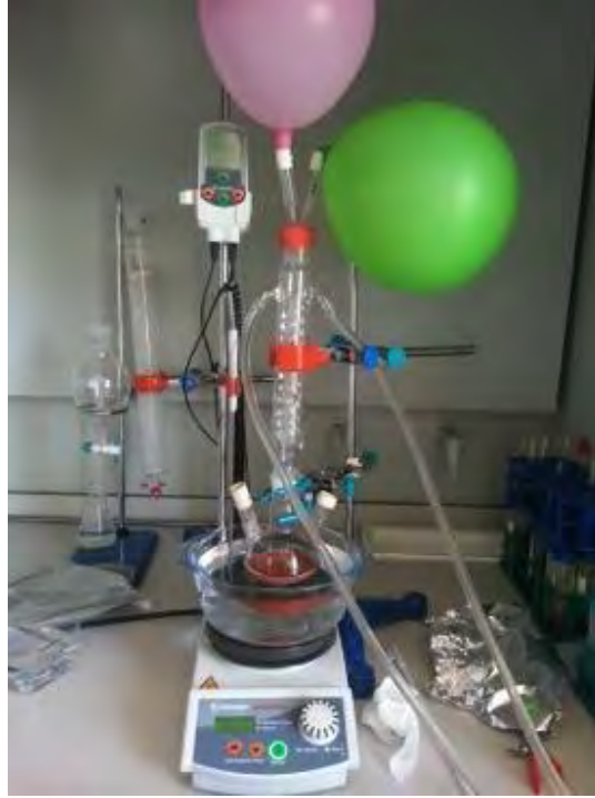
Şekil 1. Azot altında yapılan çalışmayı gösteren deney düzeneği
