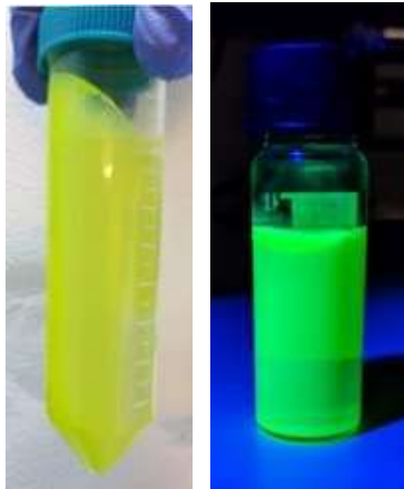
Şekil 25. Santrifüj sonunda çökelen kuantum noktacıklar ve kullanıma hazır kuantum noktacıkların UV ışığı altındaki görüntüsü
