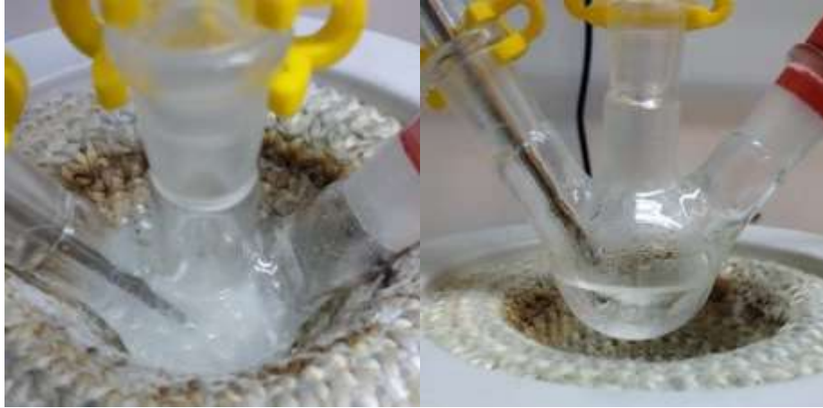
Şekil 11. Vakum altında gaz çıkışı ve ısıtma sonrasında oluşan berrak çözelti
