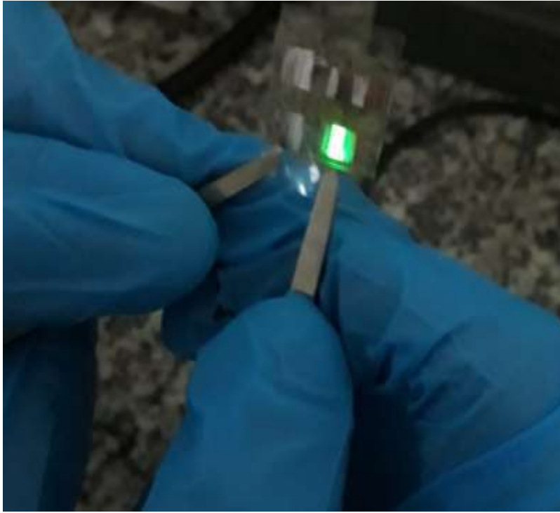
Şekil 102. Yeşil ışık yayan esnek PET tabanlı QLED
