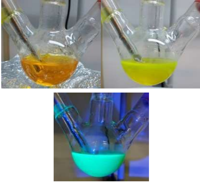
Şekil 13. Tamamlanan sentezin yüksek sıcaklık, oda sıcaklığı ve UV ışığı altındaki görüntüleri
