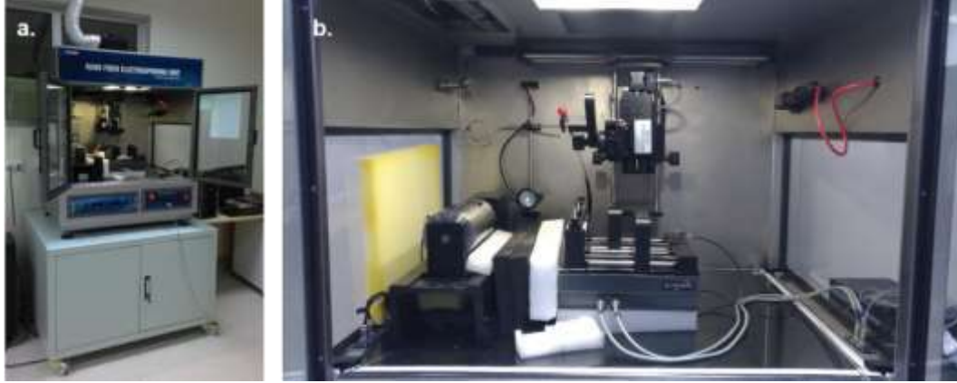
Şekil 7. Projede kullanılan ES cihazının görüntüleri. a: Genel görünüş, b: içten görünüşü.
