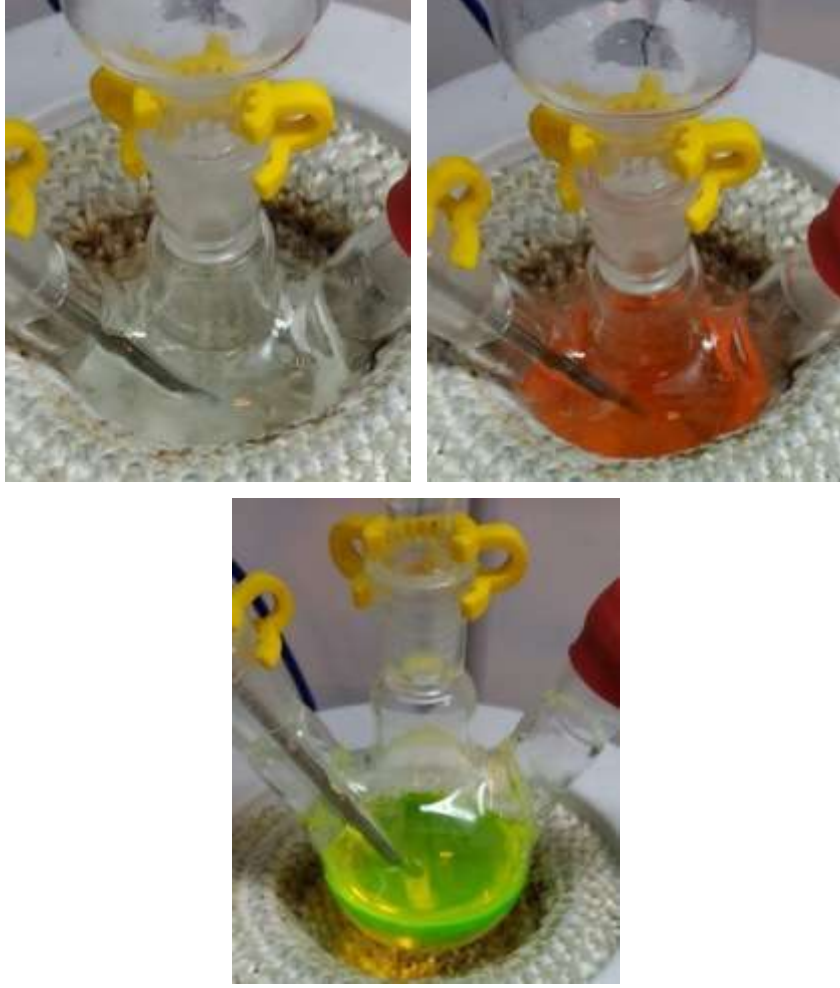
Şekil 24. Çekirdeklenme öncesi berrak çözelti ve enjekte edilen TOP-S-Se çözeltisi sonrasında önce turuncu sonra yeşile dönen çözelti
