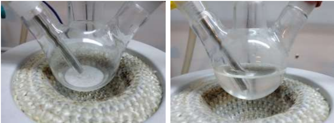
Şekil 23. Sentezin başında flaska yerleştirilen malzemeler ve yüksek sıcaklıkta oluşan berrak çözelti
