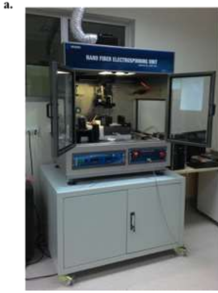
Şekil 30. Proje çalışmalarında kullanılan elektrospınleme sistemi. a) ünitenin dıştan görüntüsü, b) ünitenin elektrospınleme prosesi sırasındaki yakından çekilmiş görüntüsü
