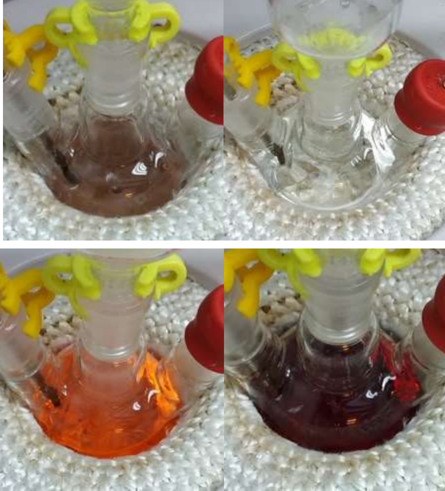
Şekil 27. a) Sentezin başlangıcında çözünmeyen kimyasallar b) Çekirdeklenme öncesi berrak çözelti c) TOP-Se sonrası renklenmenin başlaması d) sentez sonunda oluşan kırmızı renk
