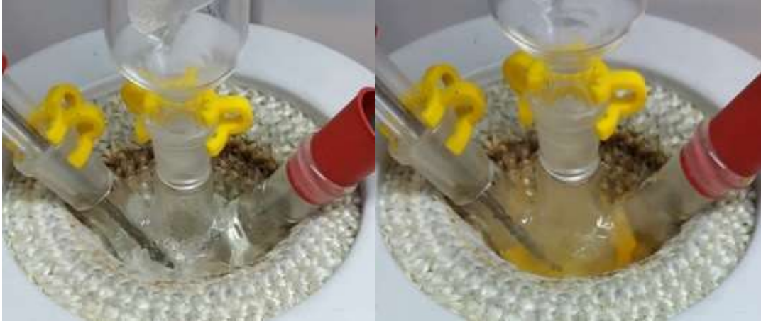
Şekil 12. TMS 3 P ekleden önceki renksiz çözelti ve ekledikten sonra oluşan kuantum noktacıkların verdiği yeşilimsi renk
