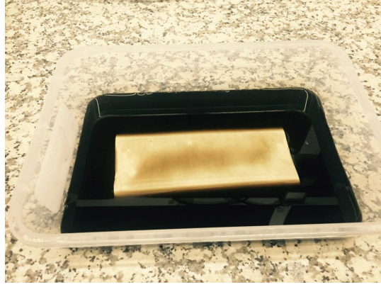
Şekil 12. Membranlarda daldırma ile modifikasyon
