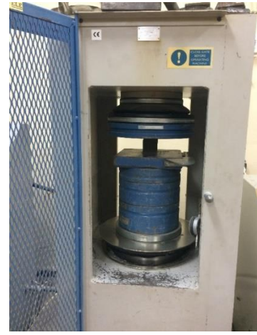
Şekil 6. Tek eksenli basınç dayanımının belirlendiği cihaz
